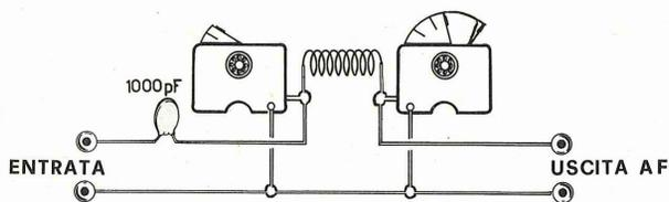
Fig. 14. Se per accordare il filtro a pi-greco fosse necessario ruotare il condensatore d'entrata alla sua massima capacità, mentre quello d'uscita alla sua minima capacità, anziché agire sul valore del condensatore d'accoppiamento, è più conveniente modificare il filtro a pi-greco come vedesi nelle figg. 15-16.
