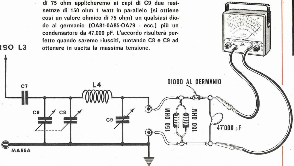
Se possedete un voltmetro elettronico, usatelo al posto del tester, perché quest'ultimo vi indicherà una tensione inferiore a quella realmente esistente. Comunque anche se il tester non ci permetterà di conoscere esattamente la tensione di uscita, ci indicherà sempre con assoluta precisione la posizione esatta di accordo di C8 e di C9.
