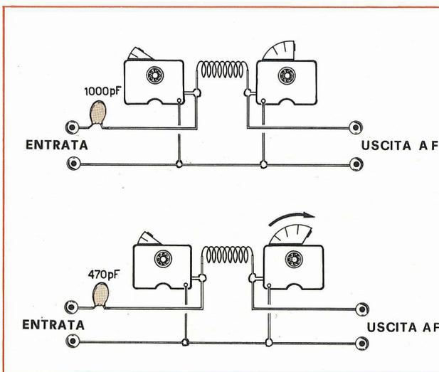
Fig. 10. Utilizzando come condensatore d'accoppiamento una capacità da 1.000 pF. si potrà notare, nei trasmettitori a transistor, che per accordare il filtro a pi-greco su ad una impedenza d'uscita di 52-75 ohm il condensatore variabile d'entrata dovrà presentare una capacità maggiore rispetto a quello d'uscita.
