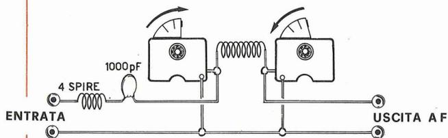
Fig. 15. Inserendo prima del condensatore d'accoppiamento una bobina composta da 3-4 spire, si noterà che per accordare il filtro a pi-greco, sarà necessario ridurre la capacità del condensatore variabile d'entrata ed aumentare quello di uscita.
