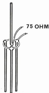
**Fig. 5B.** Ponendo i bracci orizzontali in posizione verticale, inclinandoli verso il basso l'impedenza della ground-plane assumerebbe un valore di 75 ohm.
