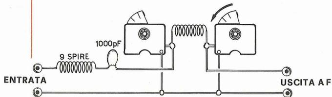
Fig. 16. Aumentando il numero delle spire di questa bobina da 4 a 9 sarà necessario aumentare ancor di più la capacità del condensatore d'uscita. Con l'aiuto di una sonda di carico o con un wattmetro si stabilirà quali delle tre soluzioni indicate ci permetterà di ottenere in uscita la massima tensione A.F.
