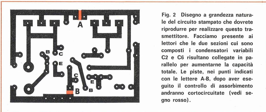
Fig. 2 Disegno a grandezza naturale del circuito stampato che dovrete riprodurre per realizzare questo trasmettitore. Facciamo presente ai lettori che le due sezioni cui sono composti i condensatori variabili C2 e C6 risultano collegate in parallelo per aumentarne la capacità totale. Le piste, nei punti indicati con le lettere A-B, dopo aver eseguito il controllo di assorbimento andranno cortocircuitate (vedi segno rosso).
