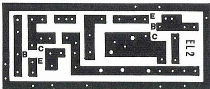
Fig. 2 Nella figura è visibile il disegno a grandezza naturale del circuito stampato. Coloro che volessero autocostruirselo consigliamo di impiegare per tale scopo una basetta in fibra di vetro onde ridurre al minimo le perdite di AF e conseguentemente aumentarne la portata kilomtrica.
