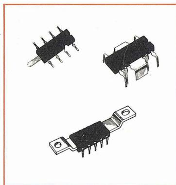
Due integrati di BF che si riescono a trovare facilmente in commercio ed a prezzi accessibili sono il TAA621 ed il TAA621/B della SGS (Società Generale Semiconduttori AGRATE Milano). Questi due integrati sono particolarmente indicati come amplificatori di BF per giradischi per radio o TV, o per altri impieghi quali modulatori per piccoli trasmettitori, interfonni ecc.
