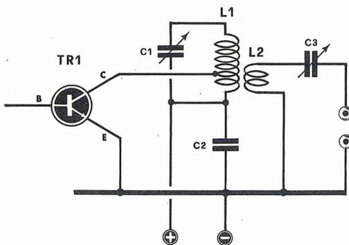
Fig. 8A. Come nel caso precedente per adattare l'impedenza d'uscita su ad un valore ben definito si dovrà applicare ai capi d'uscita una resistenza di carico, quindi cercare di ottenere la massima tensione in uscita ruotando il condensatore C3.
