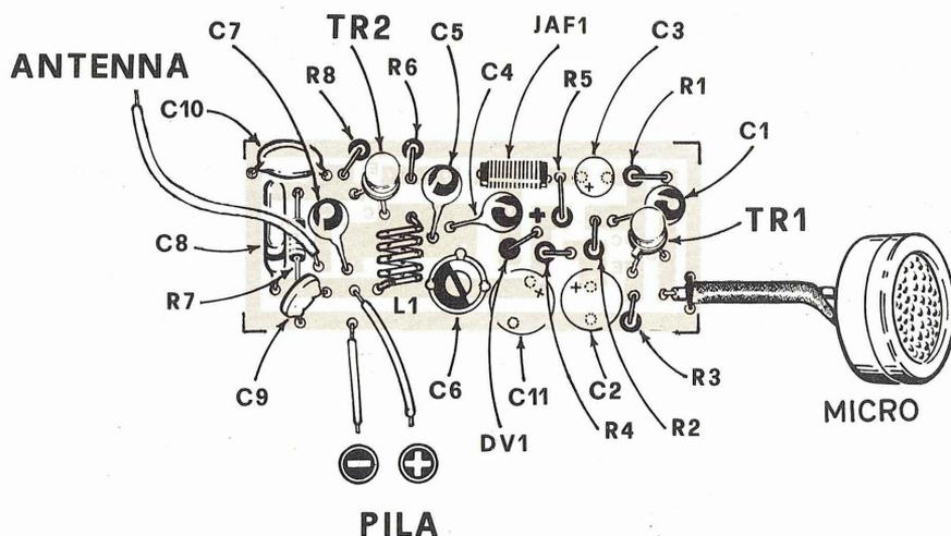
Fig. 3 Disposizione dei componenti del radiomicrofono EL 2 sulla bauletta del circuito stampato. Consigliamo i lettori a prestare attenzione alla polarità dei condensatori elettrolitici C2-C3-C11 (nel disegno è chiaramente visibile da quale lato va collegato il terminale positivo) e ai terminali E-B-C dei due transistor. Se impiegate per il microfono un cavetto schermato ricordatevi di collegare la calza metallica alla pista di massa del circuito stampato.
