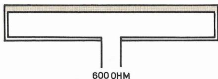
Fig. 3. Se si impiegasse per il filo superiore un diametro maggiore rispetto a quello inferiore, si constatarebbe che l'impedenza caratteristica di tale antenna dai 300 ohm iniziali passerebbe ad un valore più elevato, esattamente sui 600 ohm.
