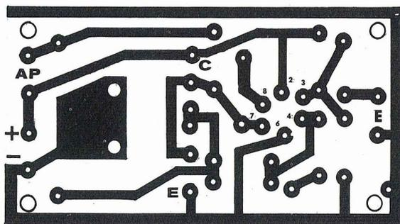
Fig. 4. Circuito stampato a grandezza naturale per realizzare un amplificatore da 3 Watt, impiegando come finali gli AC187/AC188K. Tale circuito non essendo reperibile occorrerà autoproparselo ricopiando fedelmente questo disegno.
