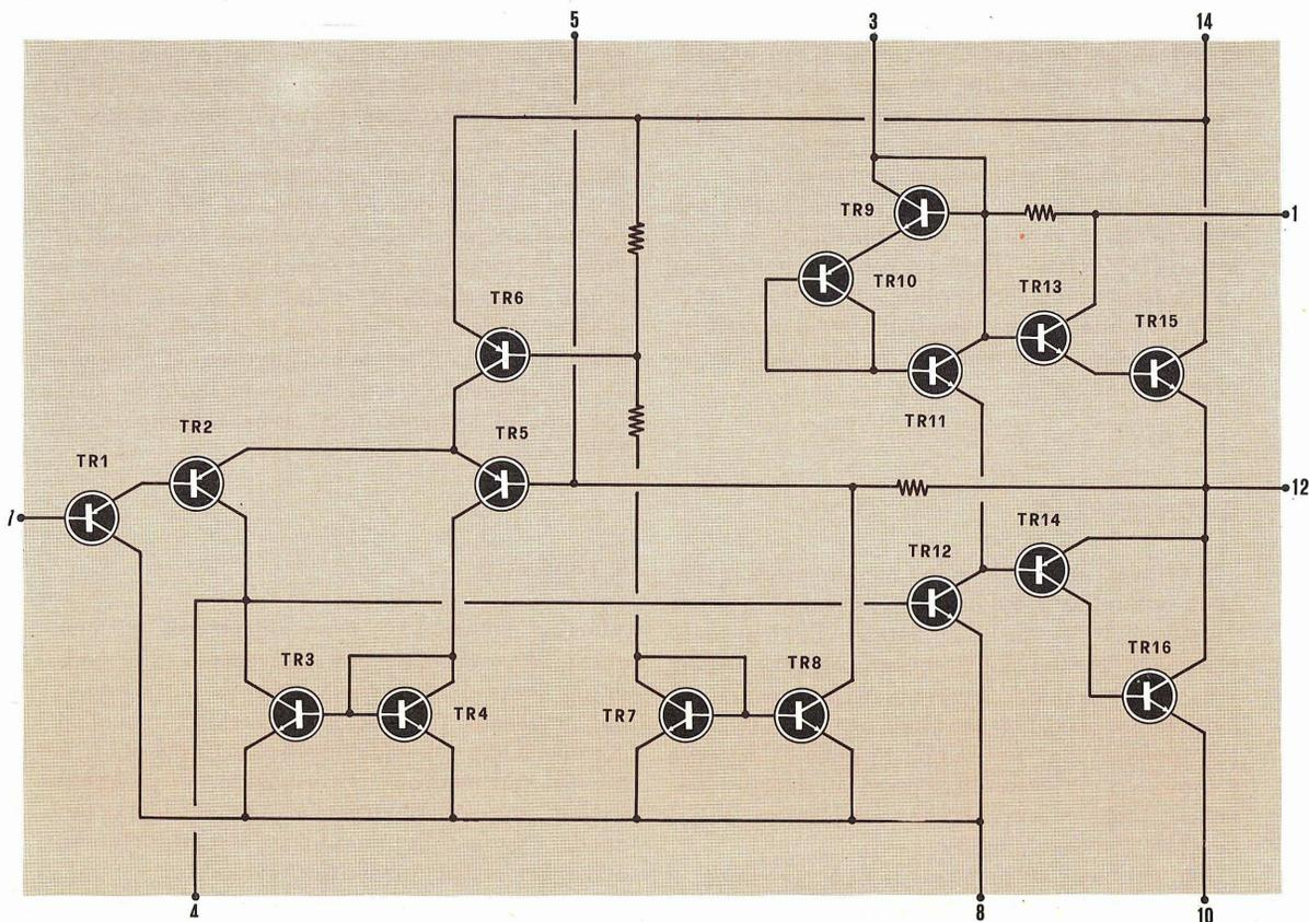
**Fig. 4** Nell'interno dell'integrato TAA. 611B sono inclusi come vedesi in disegno 16 transistor. Il circuito è completo di stadio preamplificatore di quello pilota e dello stadio finale di potenza costituito dai transistor TR 15 e TR 16.
