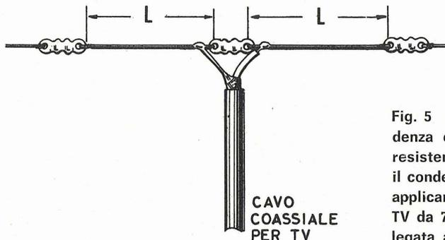
Fig. 5 Tarato il filtro a pi-greco sulla impedenza di 75 ohm potremo togliere le due resistenze di carico, il diodo al germanio, il condensatore da 47000 pF (vedi fig. 4) ed applicare in sua vece un cavo coassiale per TV da 75 ohm (la calza metallica andrà collegata alla massa). L'estremità del cavo si collegherà ad un'antenna come indicato in figura. La lunghezza dei bracci L si calcolerà secondo la formula indicata in articolo.
