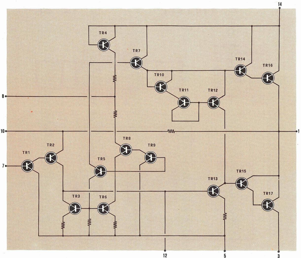
**Fig. 1** Nell'interno dell'integrato TAA.621 sono inclusi come vedesi in disegno ben 17 transistor. Il circuito è sostanzialmente composto da uno stadio preamplificatore, da uno stadio pilota e da uno stadio finale in classe AB quasi complementare in grado di fornire in funzione della tensione di alimentazione e dalla resistenza dell'altoparlante una potenza variabile da 1,4 a 4 Watt.
