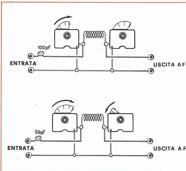
Fig. 12. Impiegando una capacità di accoppiamento ancora più ridotta, 100 pF. ad esempio, per ottenere in uscita la massima tensione di AF dovremo ridurre la capacità del condensatore di entrata rispetto all'accordo che si riusciva ad ottenere con una capacità di accoppiamento da 1.000 pF.
