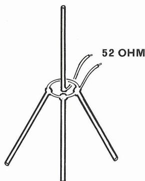
**Fig. 5A.** Se incliniamo nella ground plane i bracci orizzontali verso il basso l'impedenza caratteristica aumenterebbe passando dai 35 ohm iniziali su ad un valore di 52 ohm.
