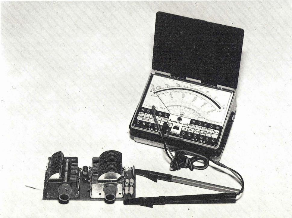
Fig. 4 Per poter adattare l'impedenza d'uscita del nostro trasmettitore alla impedenza caratteristica di 75 ohm applicheremo ai capi di C9 due resistenze di 150 ohm 1 watt in parallelo (si ottiene così un valore ohmico di 75 ohm) un qualsiasi diodo al germanio (OA81-OA85-OA79 - ecc.) più un condensatore da 47.000 pF. L'accordo risulterà perfetto quando saremo riusciti, ruotando C8 e C9 ad ottenere in uscita la massima tensione.
