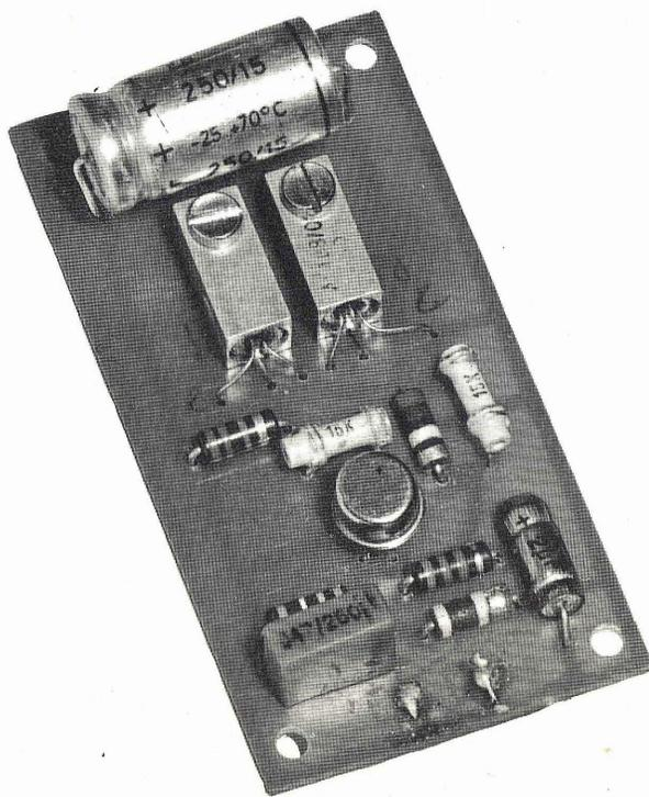
**IN ALTO** come si presenta l'amplificatore descritto in articolo già montato sulla basetta del circuito stampato.
