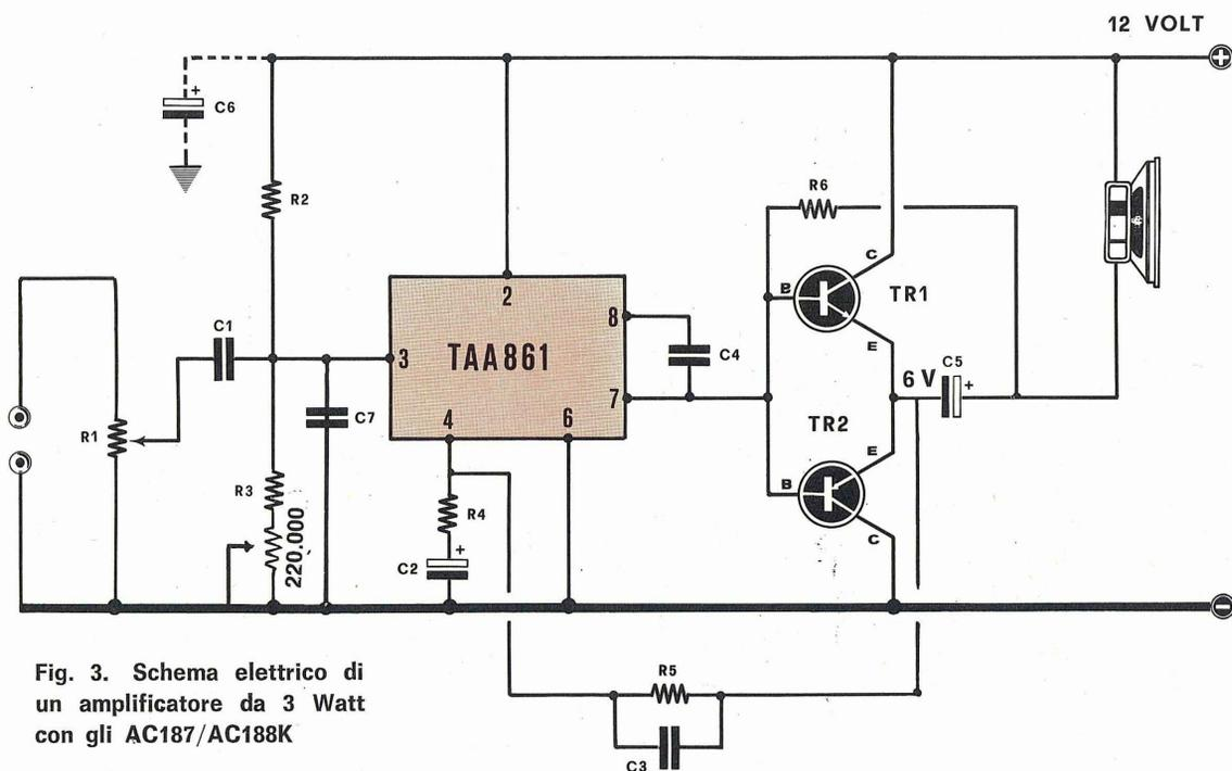
Fig. 3. Schema elettrico di un amplificatore da 3 Watt con gli AC187/AC188K
