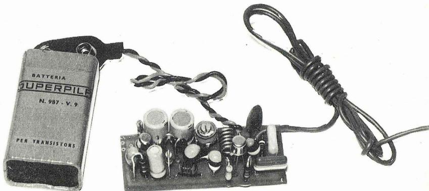
4 - Lavorando sulle onde medie e corte in AM è necessaria una maggior potenza per coprire la stessa distanza raggiungibile sulle VHF per cui, tanto per fare un esempio, se con il nostro apparecchio in FM possiamo agevolmente raggiungere il chilometro, sulle onde corte in AM dovremmo accontentarci, alle stesse condizioni di potenza ed ambientali, di coprire a malapena 100 metri e sulle onde medie addirittura un massimo di una decina di metri.
