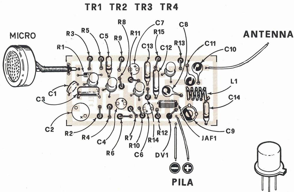
Fig. 3 I componenti relativi allo schema del radiomicrofono EL 4 andranno disposti sulla basetta del circuito stampato come vedesi in disegno. Ci raccomandiamo di rispettare la polarità dei condensatori elettrolitici C2-C4-C6-C7, e di controllare la disposizione dei terminali E-B-C dei transistor, non essendo stato possibile riportare tale indicazione sul circuito stampato.
