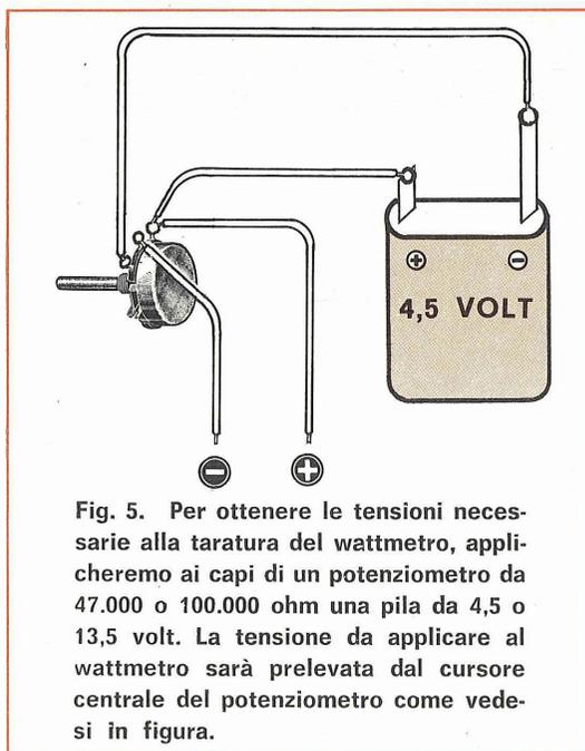
**Fig. 5.** Per ottenere le tensioni necessarie alla taratura del wattmetro, applicheremo ai capi di un potenziometro da 47.000 o 100.000 ohm una pila da 4,5 o 13,5 volt. La tensione da applicare al wattmetro sarà prelevata dal cursore centrale del potenziometro come vedesi in figura.
