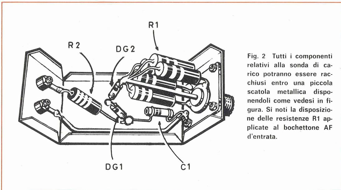
Fig. 2 Tutti i componenti relativi alla sonda di carico potranno essere racchiusi entro una piccola scatola metallica disponendoli come vedesi in figura. Si noti la disposizione delle resistenze R1 applicate al bochetto AF d'entrata.
